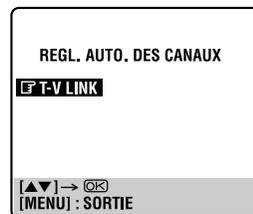
Les positions pré-réglées indiquées sur le panneau d'affichage croissent à partir de "CH1"; ne PAS appuyer sur des touches du magnétoscope ou de la télécommande avant que le panneau d'affichage montre l'heure, "(CH) 1" ou "--:--" comme illustré à la page 13.
