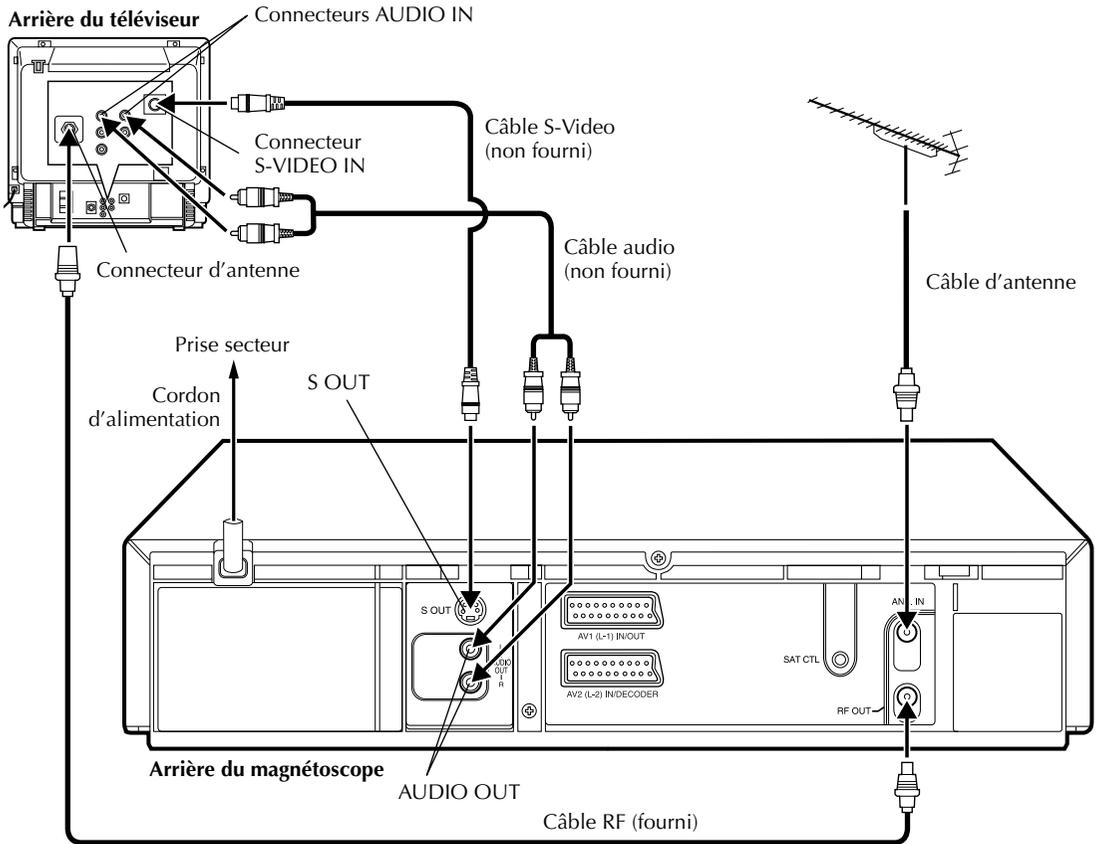
■ Pour raccorder un téléviseur avec connecteurs de S-VIDEO/AUDIO IN . . .
