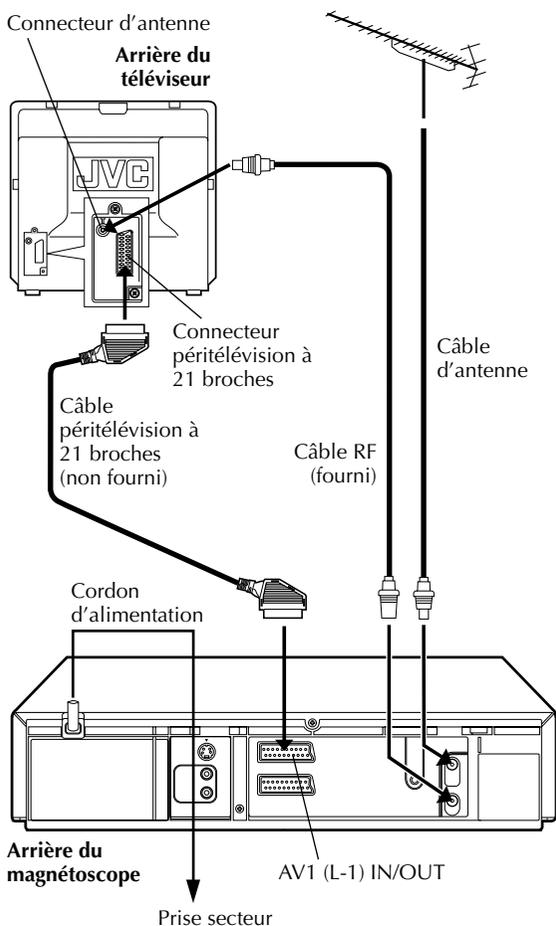
Faire le raccordement AV si votre téléviseur dispose d'un connecteur d'entrée AV péritelévision à 21 broches pour réduire les risques d'interférence. Avec un raccordement AV, il est possible d'obtenir une lecture stéréo de cassettes vidéo en utilisant un téléviseur stéréo.
